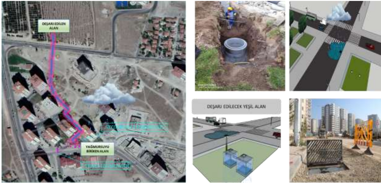
Şekil 6. KASKİ çökertme baca uygulaması
